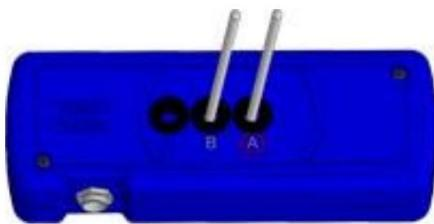
Mala udaljenost elektrode (AB) dovodi do nešto brže proizvodnje proces.
